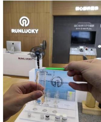
3、呈红色时，间隔逐滴滴加标准剂 A 边摇动试管，观察颜色变化，当水为纯蓝色时停止滴加，记住滴数。
