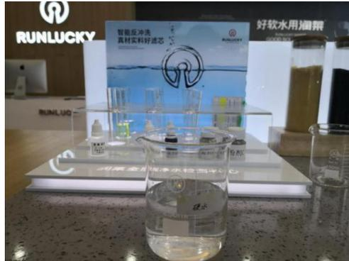
2、取 10 毫升的自来水放入试管中，加入 2 勺粉剂 A，摇匀后若变纯蓝色，说明水中硬度极低，若变红色，进行下面操作。 注意：10 毫升=2 平勺粉剂 A；
