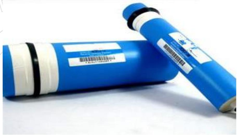
RO反渗透膜：过滤精度为0.0001微米，去除有机物、细菌、病毒、重金属离子、酸根离子，即去除水以外的一切物质，出水为纯水，过滤阻力非常大，必须加高压水泵增压才能出水。
