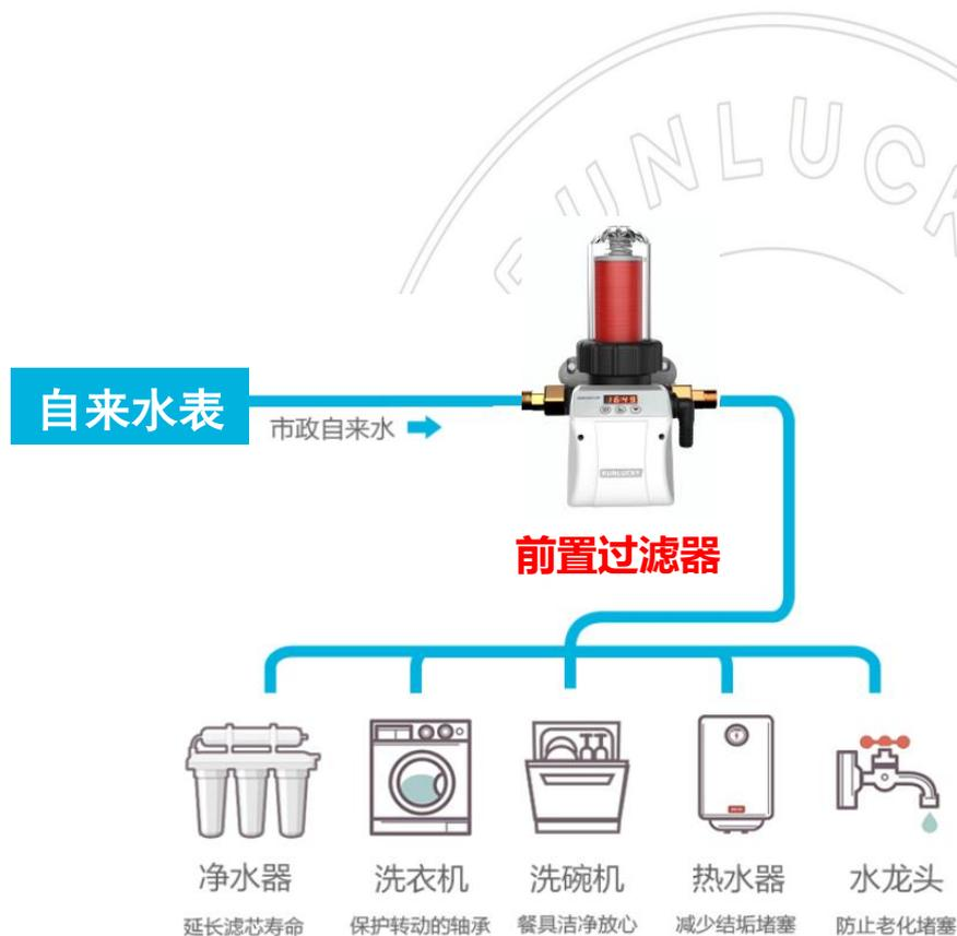
前置过滤器是对全屋用水的第一道粗过滤设备，通常安装在净水管道水表之后，用以过滤自来水供水管网二次污染中的泥沙，铁锈等较大颗粒杂质，是一种可靠的杂质性过滤装置，把好全屋净水的第一关。
